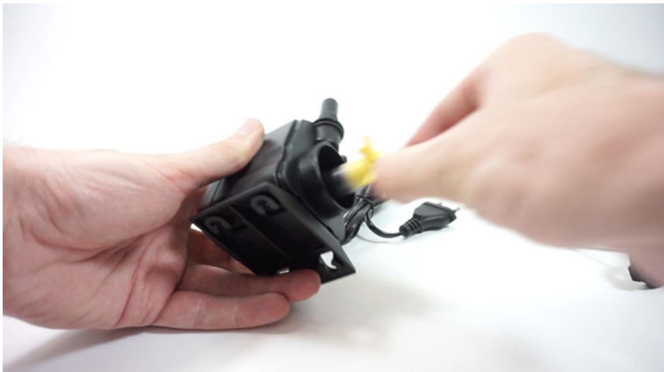
Fig. 4 - Estrarre e pulire il rotore.
