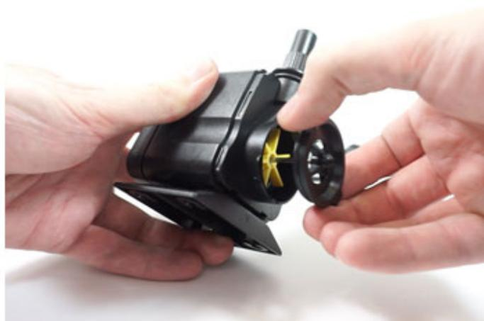
Anche le *pompe per acquario* ogni tanto vanno pulite, infatti col tempo lo sporco e il calcare si depositano nell'alloggio del rotore e sul rotore stesso, creando attrito e compromettendo l'efficienza della pompa.
