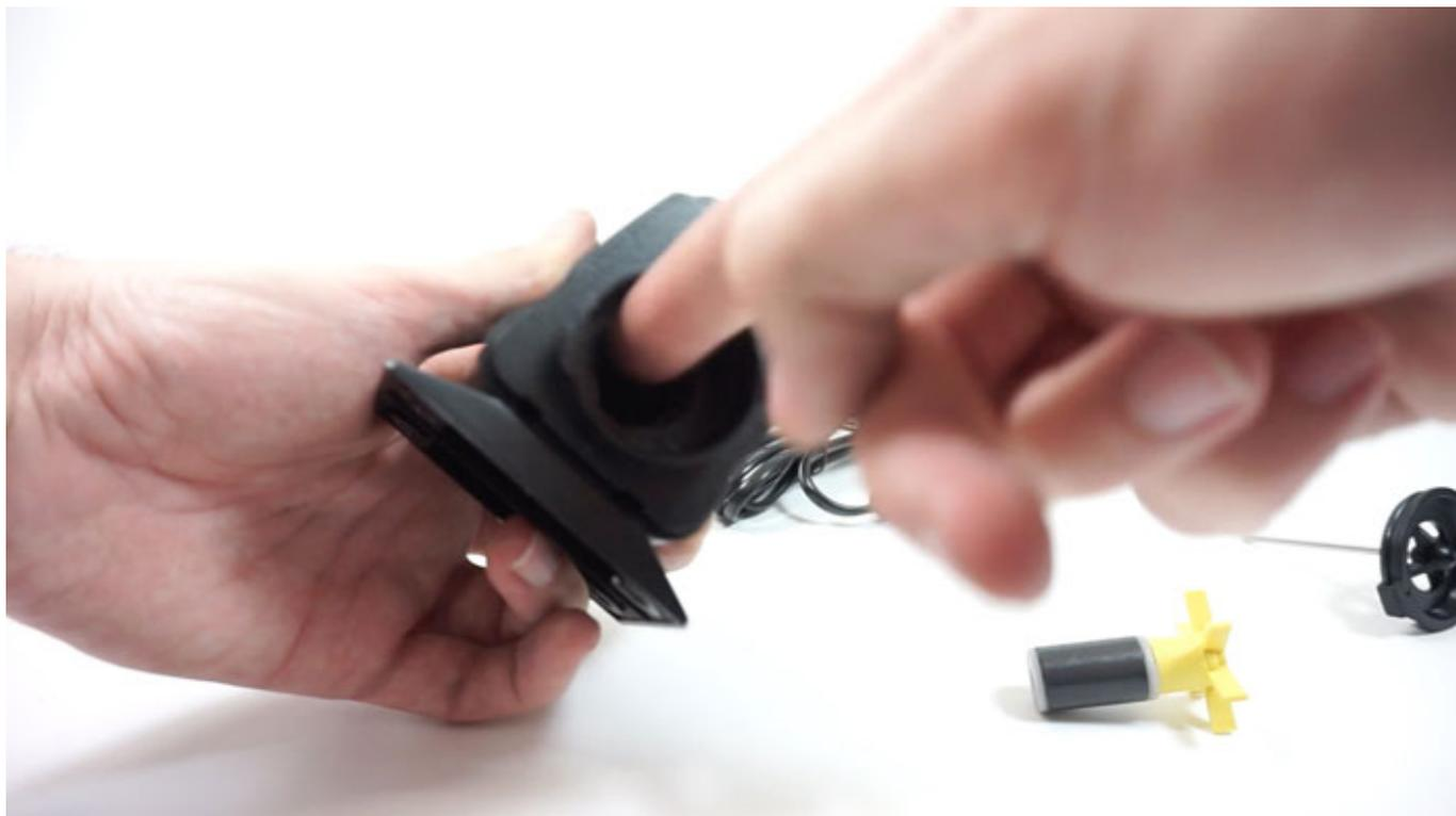
Fig. 5 - Pulire l'alloggio rotore della pompa.
